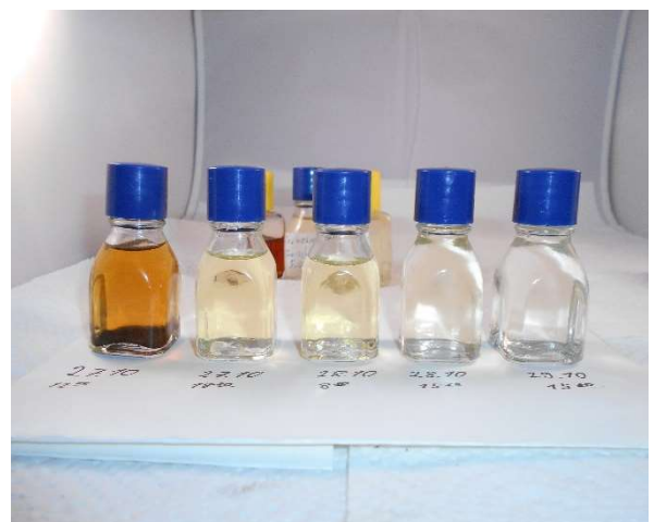
Das linke Glas zeigt das unbehandelte Medium. Von links nach rechts kann man den Fortschritt der Reinigung erkennen. Die Endanalyse des letzten Glases entspricht der Toleranz von Neuöl
