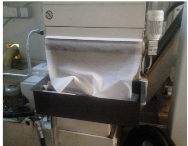
Bandfilter mit benutztem Filtertuch, nach der Reinigung des Tiefbohröls
