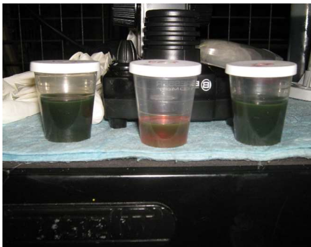
Ergebnis einer Reinigung von Hydrauliköl ISO VG HLP 46
