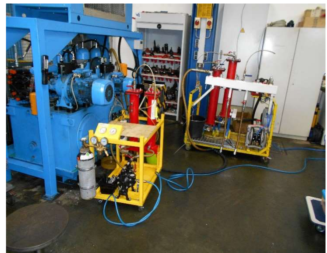
Reinigung und Trennung der eingesickerten Kühlschmierstoffe einer Karusselldrehmaschine
