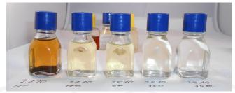
Regeneration eines Silikonöls aus einer ORC-Turbine, genutzt als Medium zur Stromerzeugung (verschmutzt und mit Schwefel belastet).
